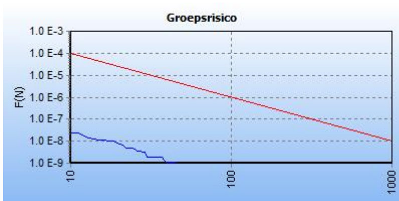
Afbeelding 8 fN-curve buisleiding A-521-1 1-deel-1, huidige situatie
