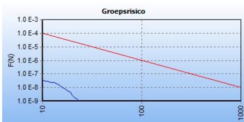
Afbeelding 16 fN-curve buisleiding Z-540-14-deel1, huidige situatie
