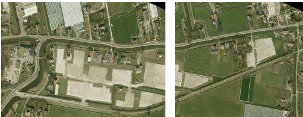
Afbeelding 3.1: Plangebied vlak na de voorbelasting. Bron: Google Maps.
