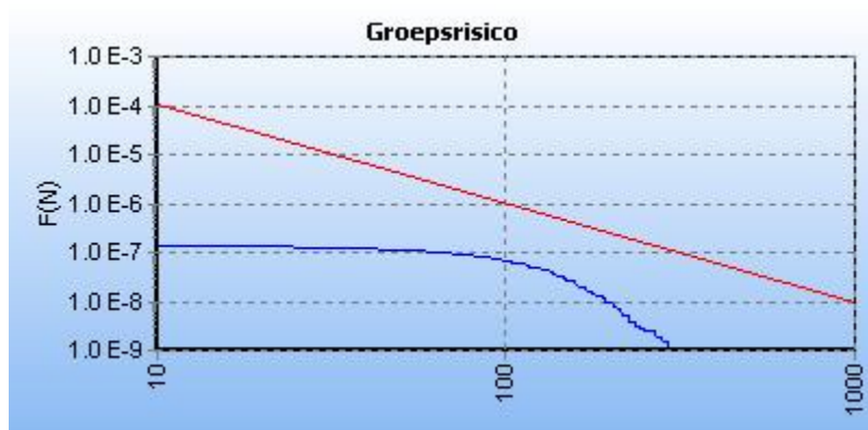
Figuur 7 : FN curve voor A-617 van N.V. Nederlandse Gasunie voor de kilometer tussen stationing 19230.00 en stationing 20230.00
