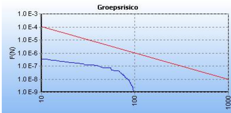
Figuur 6 : FN curve voor A-613 van N.V. Nederlandse Gasunie voor de kilometer tussen stationing 0.00 en stationing 1000.00
