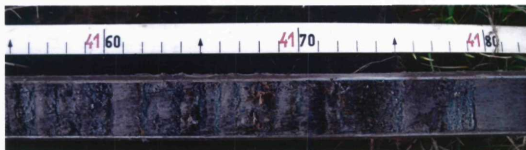
Figuur 4: Een afwisseling van klei met zand- en veenlaagjes.
