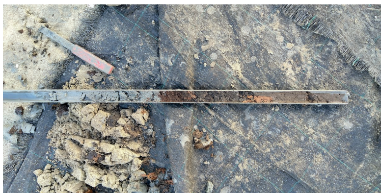
Afbeelding 10. Detail van boring 4 vanaf 3 m onder het maaiveld (2,7 m -NAP). Rechts kalkloos zand waarop een bodem zich heeft gevormd. Daarop ligt een roodbruine (bos)veenlaag die scherp overgaat naar grijze klei.
