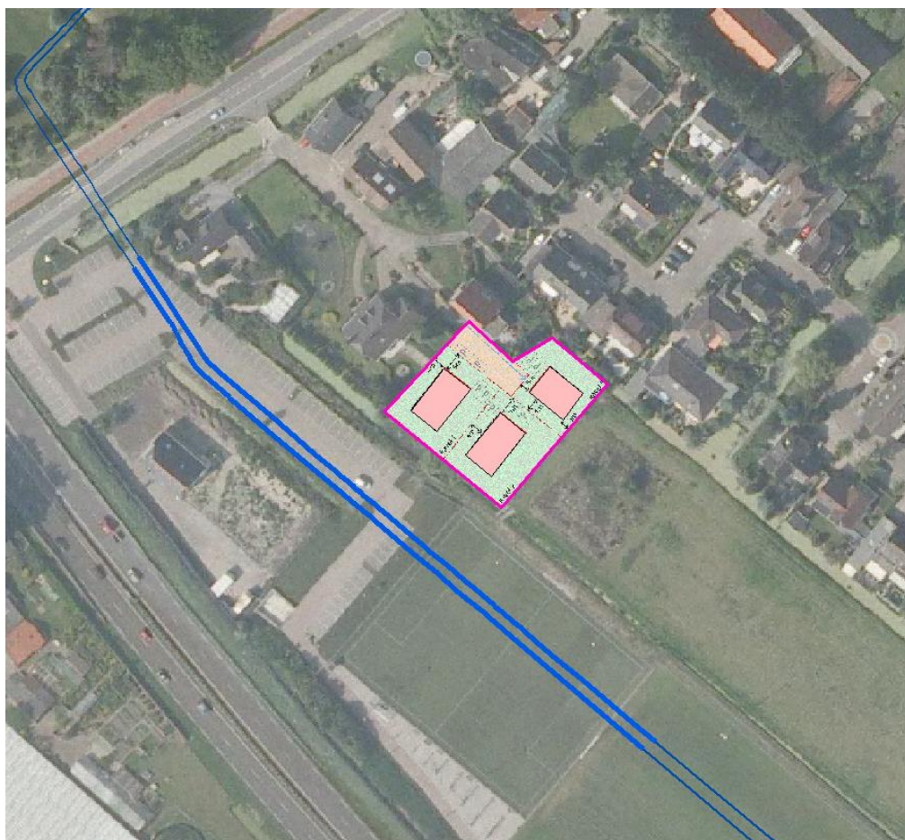
Figuur 5. In roze de geplande woningen. In blauw de gasleidingen. Het verdikte deel is het deel waar een leidingbreuk kan leiden tot een situatie waarbij bescherming binnenshuis niet toereikend is.
