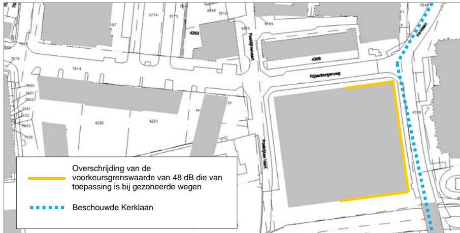
Figuur 4.4: Locaties waar ten gevolge van de Rijsenburgerweg overschrijdingen van de voorkeursgrenswaarde te verwachten zijn
