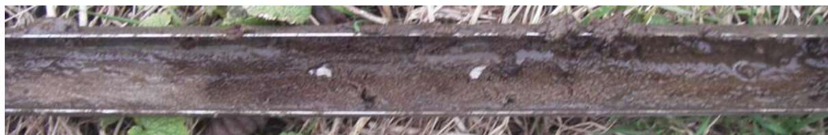
Figuur 6: Foto van boring 7 met geoxideerd, humushoudend zand.
