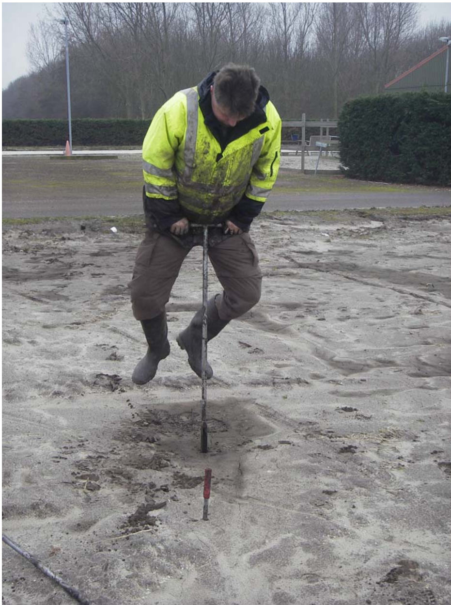
Figuur 4: Booronderzoek met behulp van een guts.
