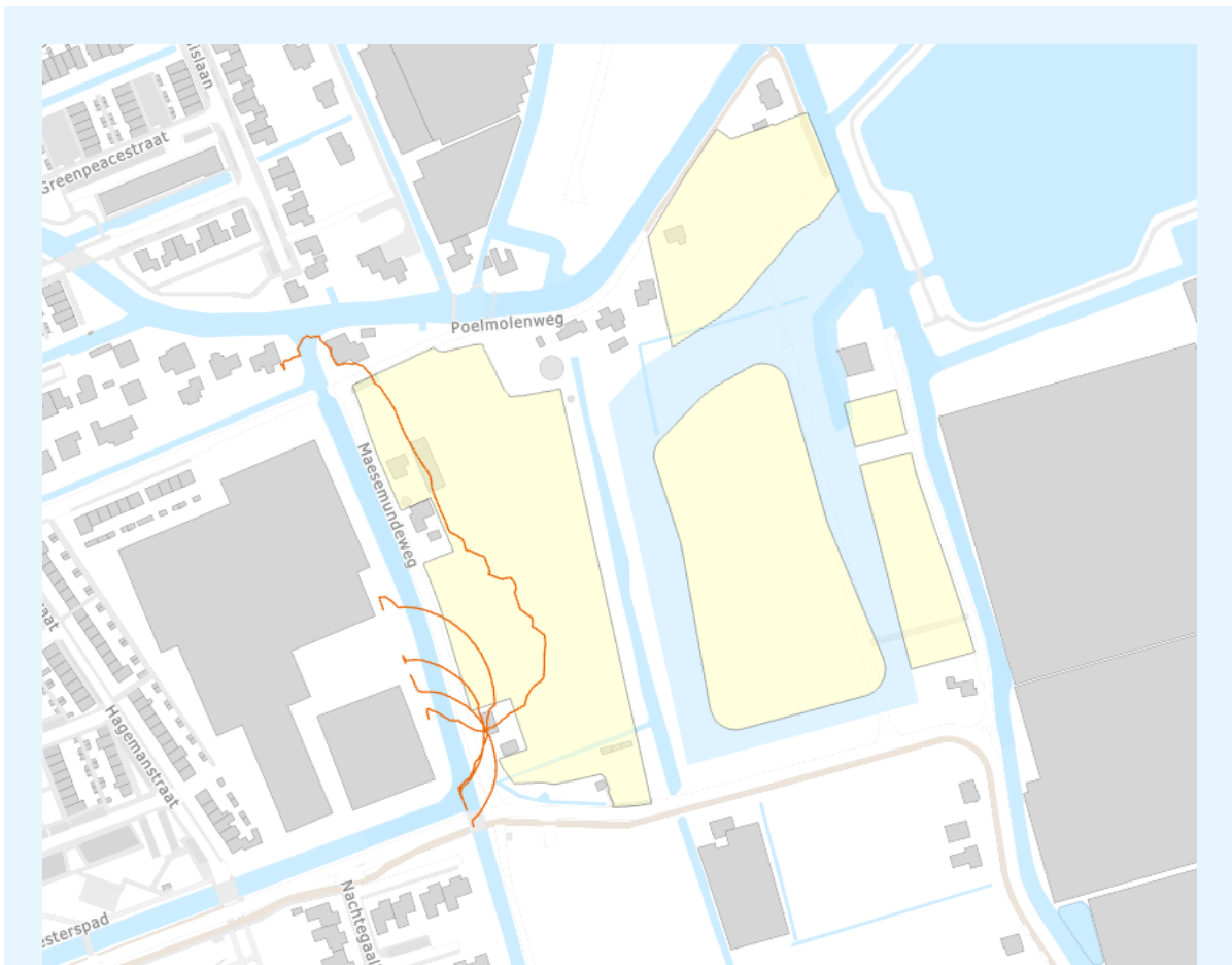
figuur B1.3: 50 dB(A) etmaalwaarde contour per bedrijf (oranje) op een hoogte van 7.5 meter
