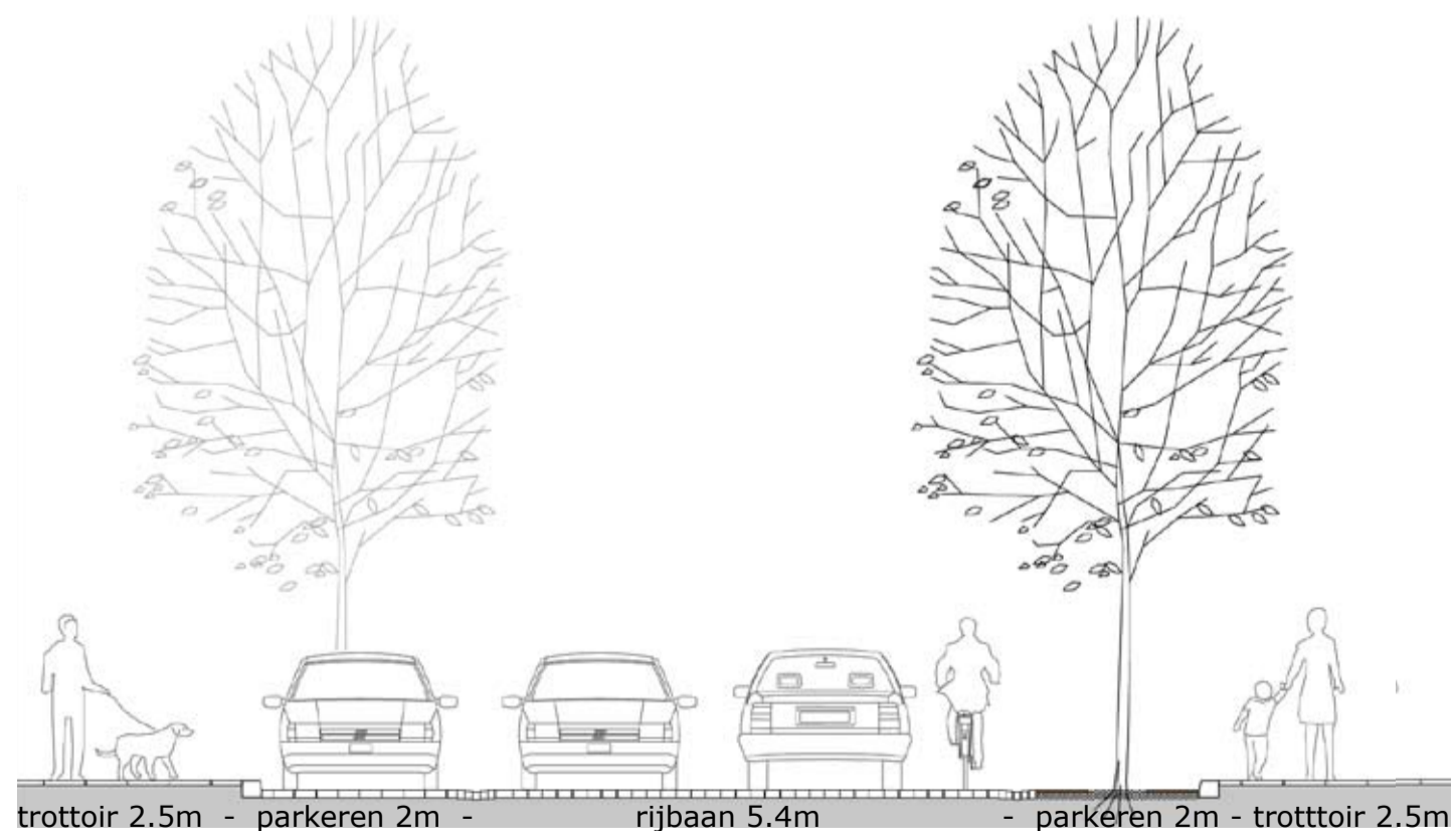
profiel woonstraat type 1: buurtontsluiting. Totaal 14.4m.
