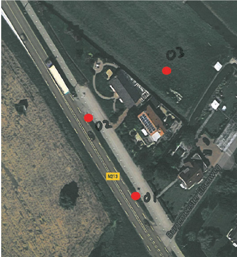
Afbeelding 3.3 Locaties boringen en metingen grondwaterstanden
