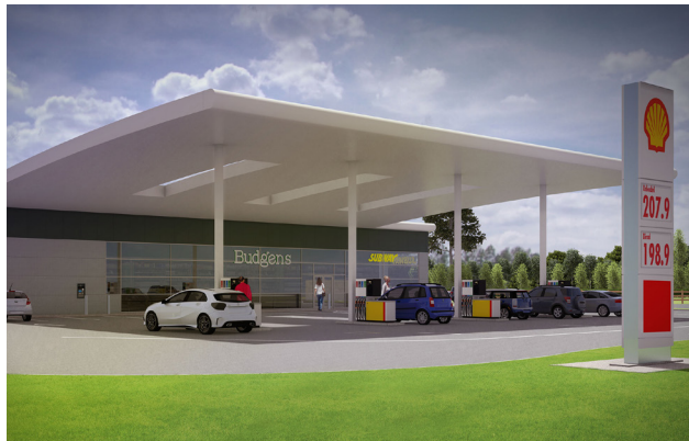
Overkapping benzinstation: dun, plat dak en smalle dimensionering van kolommen.
