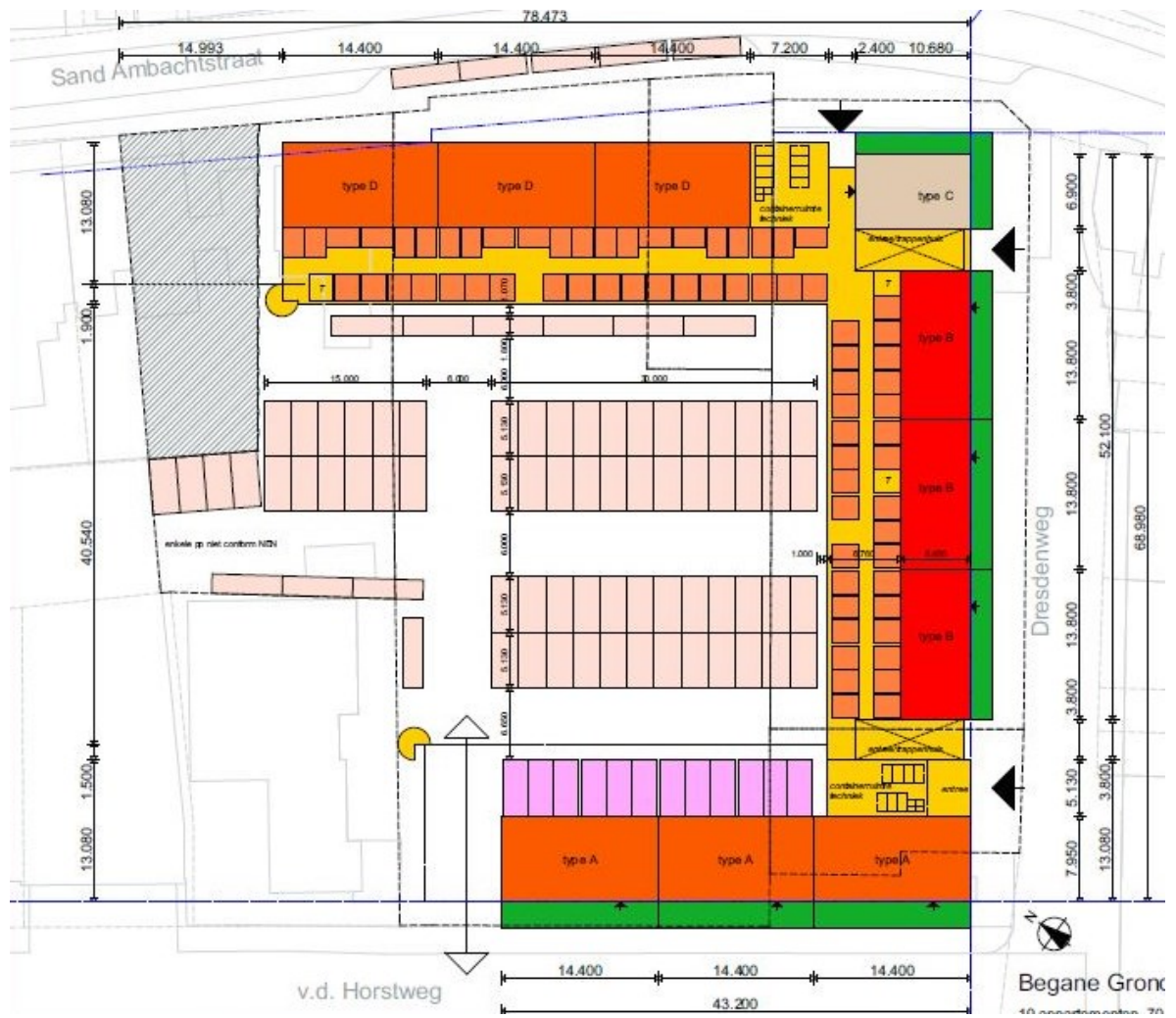
Afbeelding 2. Concept ontwerp van de toekomstige inrichting. Het noorden is linksboven (niet op schaal). De tien appartementen (oranje, rood, donker geel) liggen met voortuintjes (groen) langs de Dresdenweg en v.d. Horstweg. De zeventig bergingen liggen aan de binnenzijde. De parkeerplaatsen zijn roze en licht roze/beige en zijn centraal in het plangebied voorzien.
