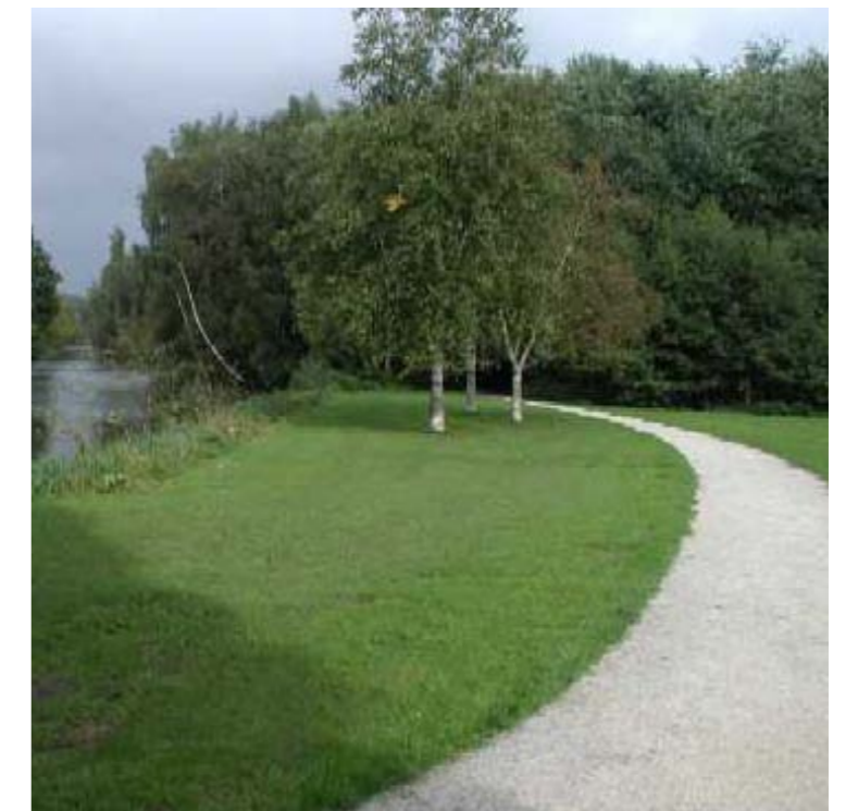
Het "karrenspoor" uitgevoerd in een asfaltverharding met sierslijtlaag
