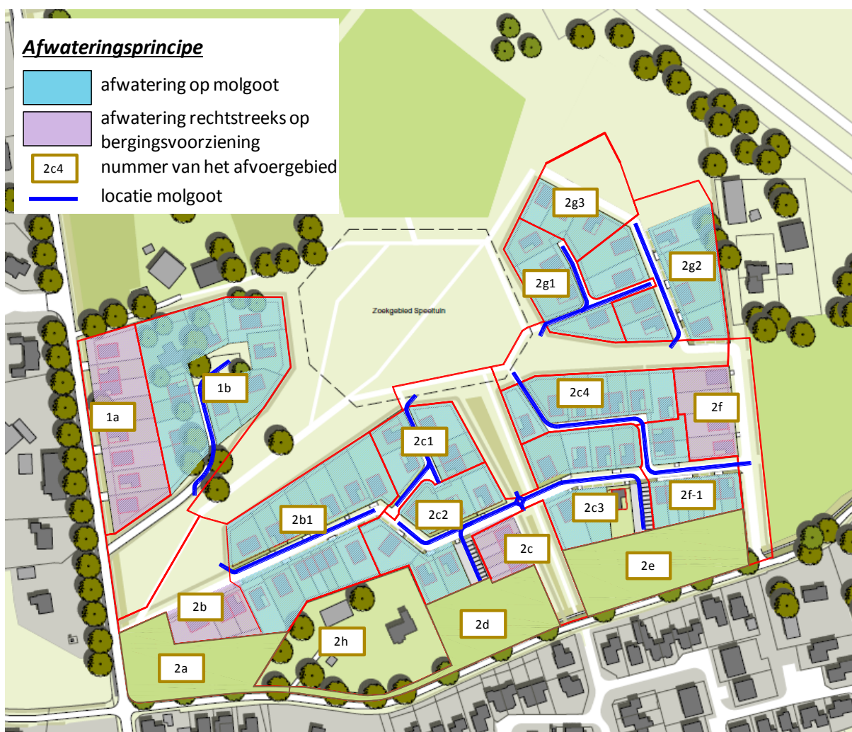
Figuur 4.1 Principe voorstel hemelwaterafvoer
