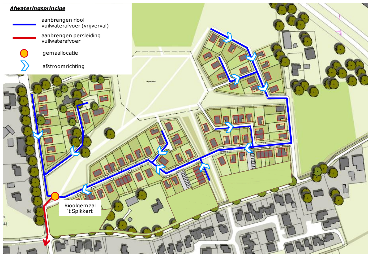
Figuur 5.1 Principe voorstel vuilwaterafvoer
