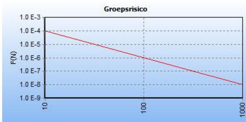
Figuur 5.1 FN curve voor 6714_leiding-N-528-21-deel-1 van N.V. Nederlandse Gasunie voor de kilometer tussen stationing 1160.00 en stationing 2160.00
