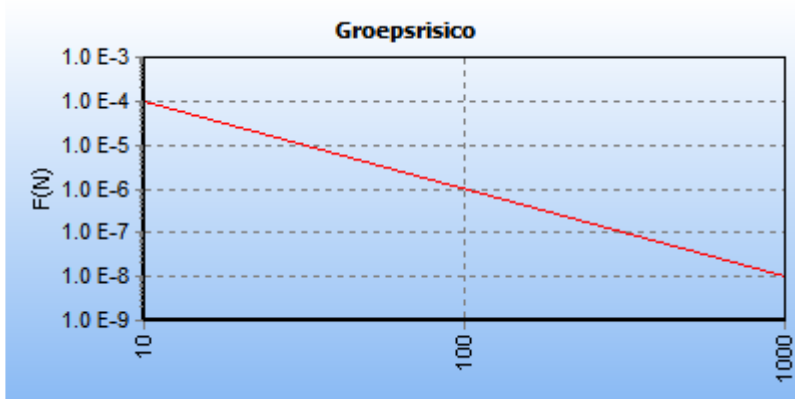
5.4 Figuur 5.4 FN curve voor 2278_leiding-Z-514-11-deel-1 van N.V. Nederlandse Gasunie voor de kilometer tussen stationing 0.00 en stationing 0.00
