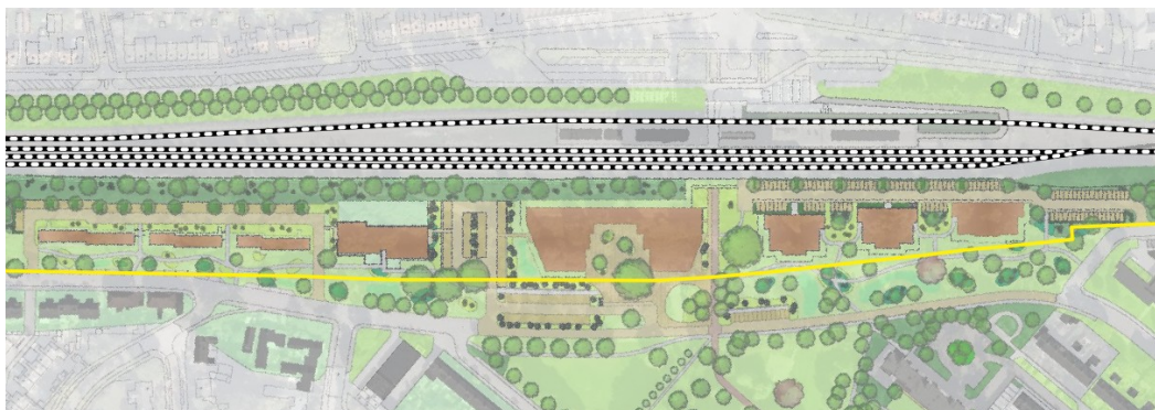
f3.1 Weergave van het plangebied inclusief spoortraject (zwart/wit) en hogedruk aardgasbuisleiding (geel)
