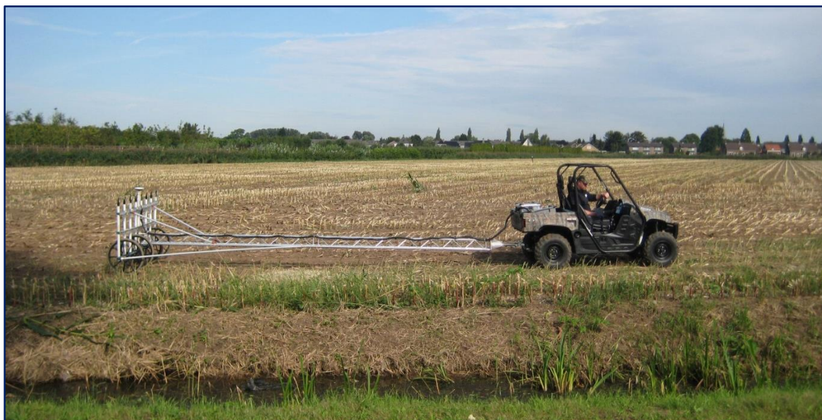
Figuur 2: 8-kanaals meetsysteem voortgetrokken door een 4x4 voertuig.
