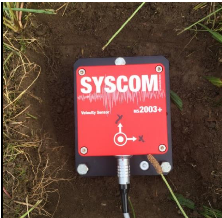
Figuur 3.2: Voorbeeld meetopstelling trillingsopnemer
