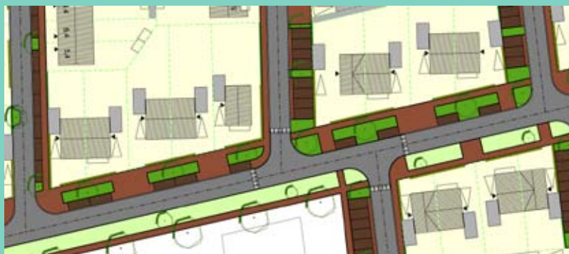
woningen staan in een hoek t.o.v. de laan, ruime kavels met vrijstaande en twee onder één kapwoningen
