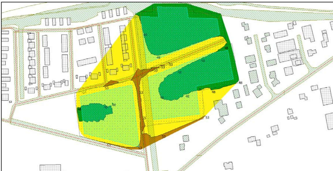
Figuur 5.1: gecumuleerde geluidbelasting ten gevolge van het wegverkeer op 7,5 meter hoogte (maatgevende hoogte)
