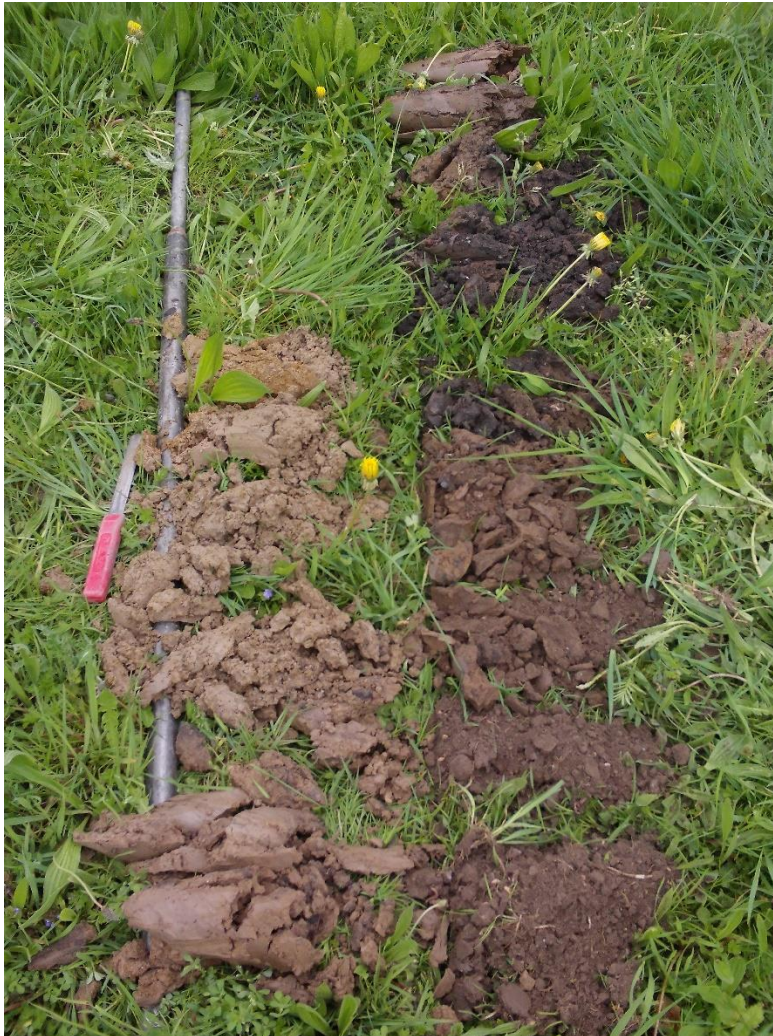
Afbeelding 4.1: Boring 5 waar rechts bovenin de oude slootbodembodem is te zien aan de hand van de sterk humeuze laag (donkere kleur).
