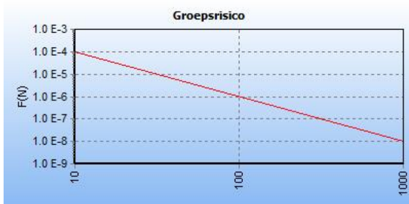
5.3 Figuur 5.3 FN curve voor 5074_leiding-N-574-12-deel-1 van N.V. Nederlandse Gasunie voor de kilometer tussen stationing 540.00 en stationing 1540.00
