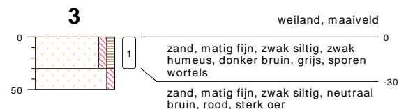
type grondboring datum 21-02-2019 boormeester J Hartman
