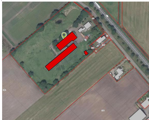
Figuur 5: Te slopen opstallen
