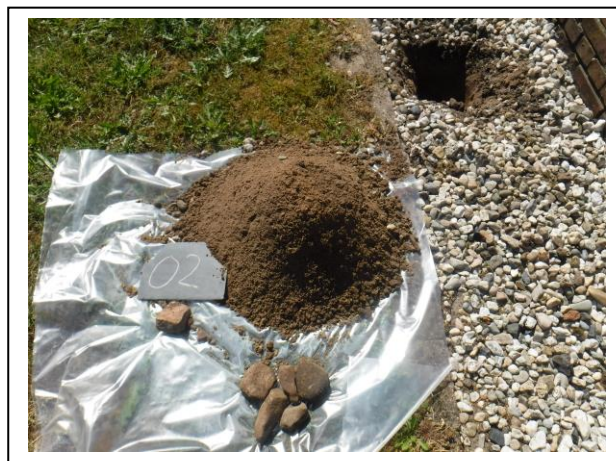
Foto 2. Opgegraven en gezeefd materiaal asbestinspectiegat 02
