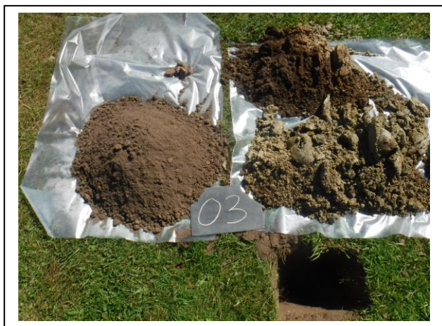
Foto 3. Opgegraven en gezeefd materiaal asbestinspectiegat 03
