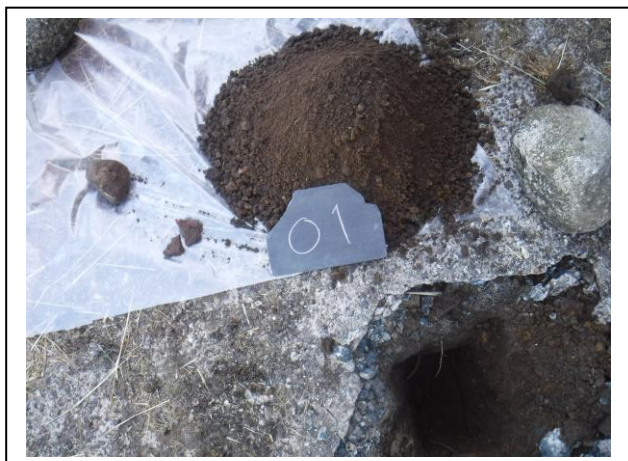
Foto 1. Opgegraven en gezeefd materiaal asbestinspectiegat 01
