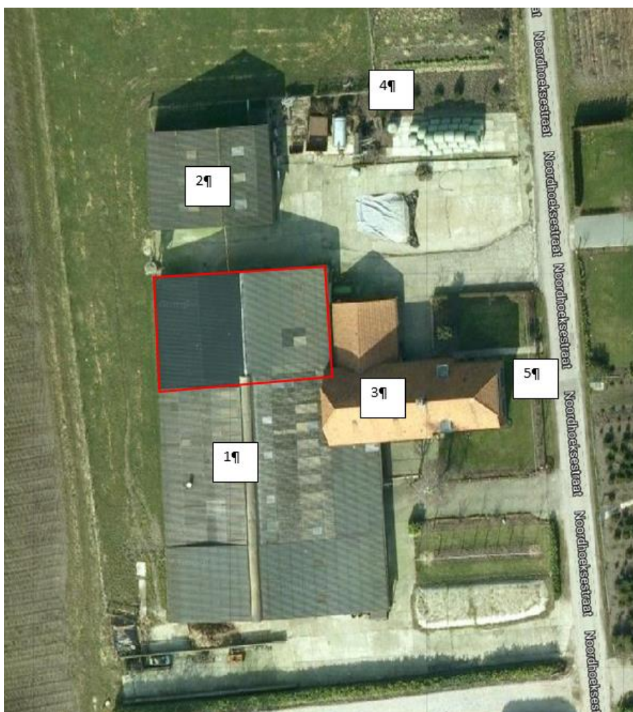
Afbeelding 2. Woonerf met indeling van compartimenten. Rood gearceerde deel wordt als laatste gesloopt.
