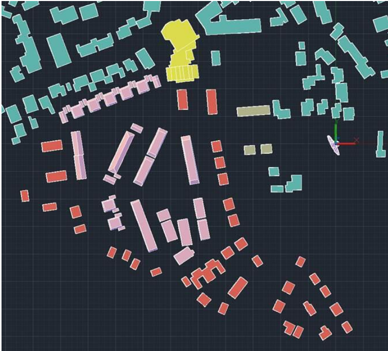
Afbeelding 3-1: Ingevoerde geometrie, top view, nieuwe situatie. De omgeving is in blauw weergegeven, de al gerealiseerde huizen in roze, het MFC in geel, de huizen met hoogte van 9.15 m in rood en de huizen met hoogte van 6.25 m in grijs.
