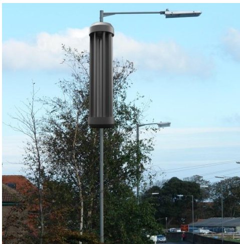
Streetblade: kleine windturbine te bevestigen aan lantaarnpalen
