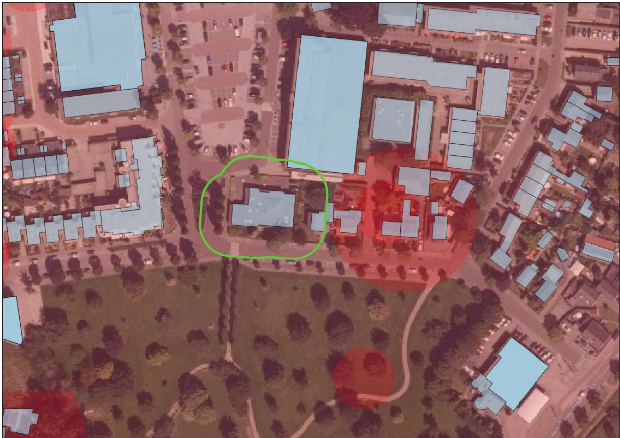
Figuur 4. De op basis van de verschillende indicaties vastgestelde verdachte gebieden (rood). In blauw de verschillende bodemroerende werkzaamheden, met name woningbouw, uitgevoerd na 1945.
