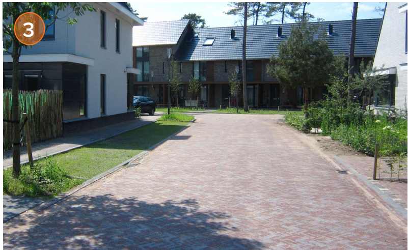
Rijbaan met een langsparkeerstrook in halfverharding, zonder verhoogde banden
