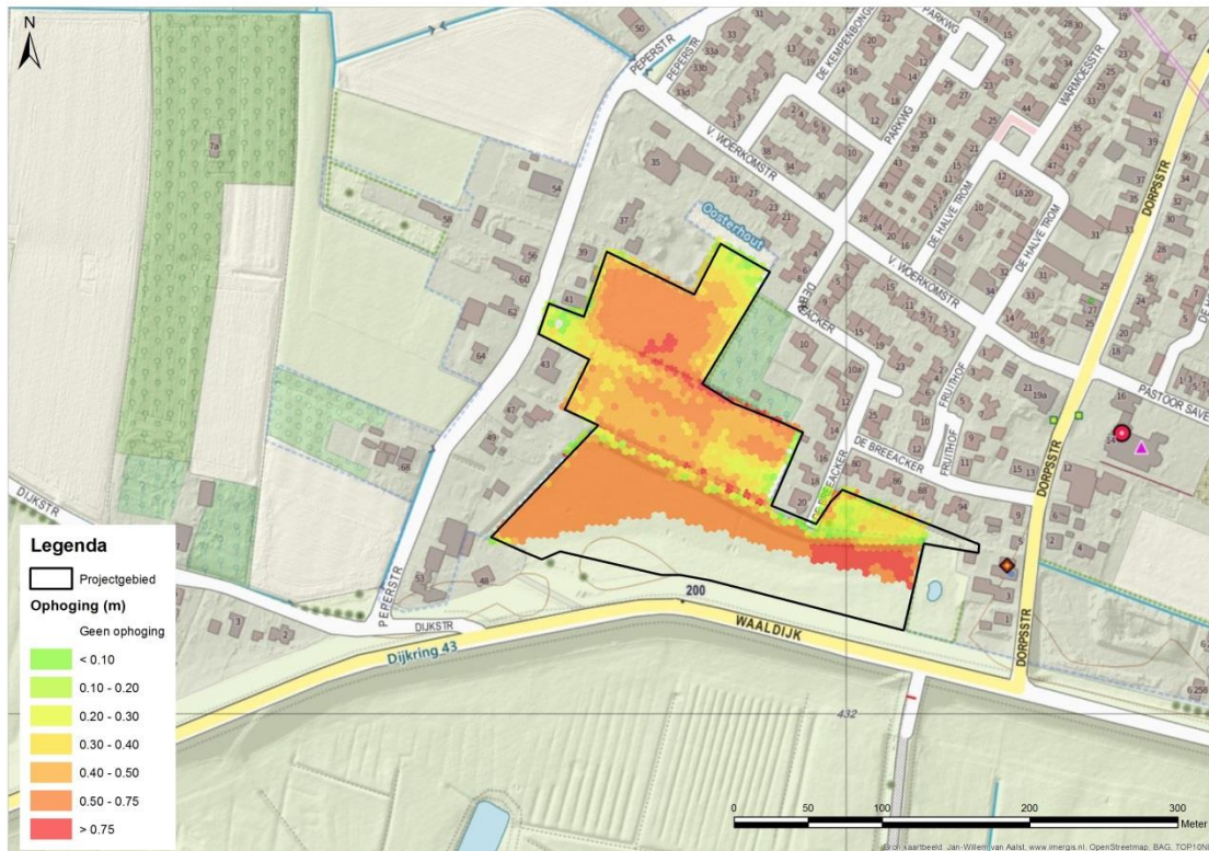
Figuur 5.6: De minimaal vereiste ophoging op basis van een ontwateringsdiepte van 40 cm (voor een weg) tijdens een T10 hoogwatersituatie.
