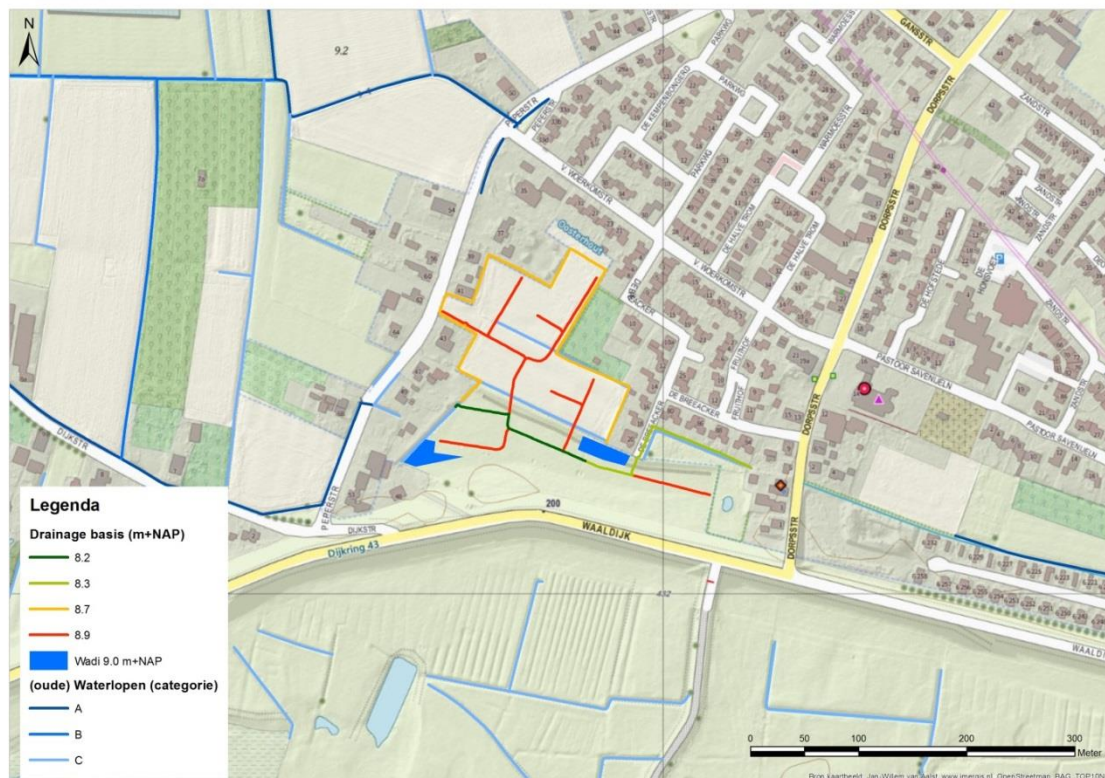
Figuur 4.3: Drainageniveaus ontwateringsmiddelen.
