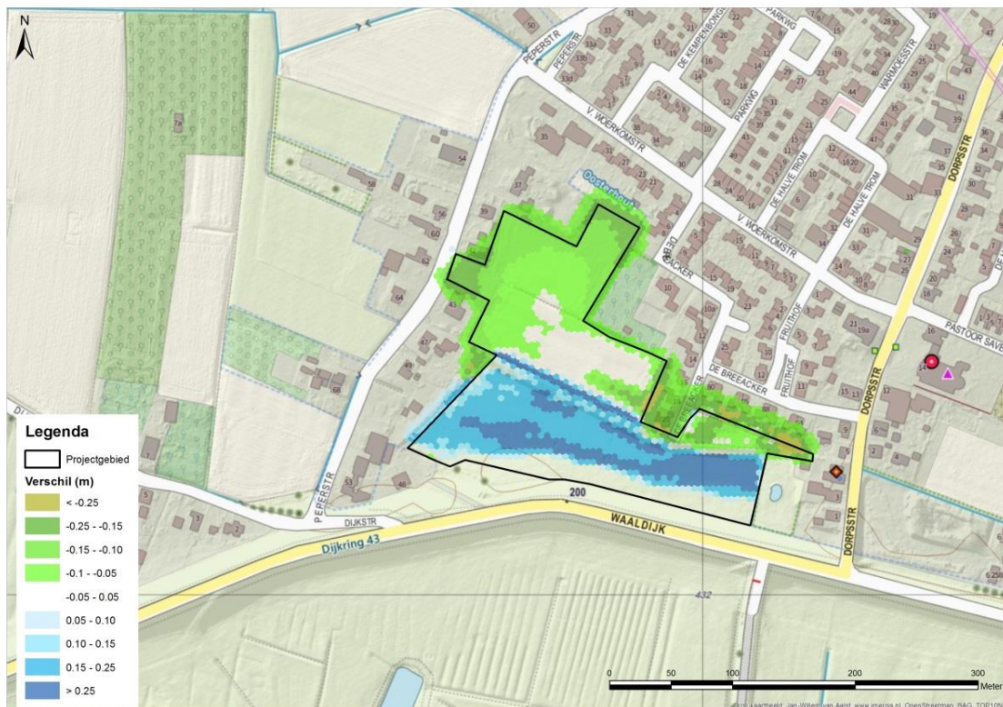
Figuur 5.1: Verandering grondwaterstand tijdens hoogwater (T10) tussen huidige situatie en toekomstige situatie (conform ontwerp).
