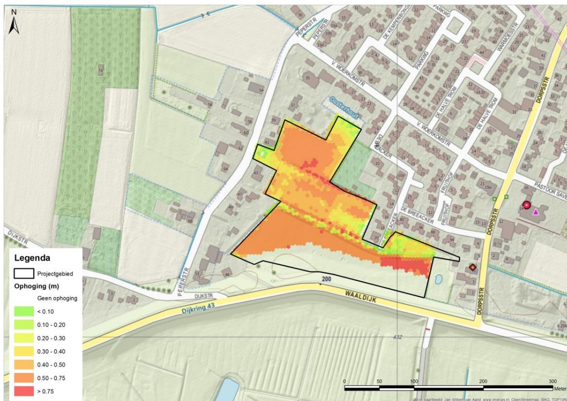
Figuur 5.12: De minimaal vereiste ophoging op basis van een ontwateringsdiepte van 40 cm en bij uitvoering van de dijkversterking.
