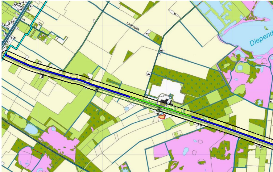
Figuur 5.1: Invloedsgebied van de leiding N-521-44 (geel gebied om de leiding omkaderd met zwarte lijn)
