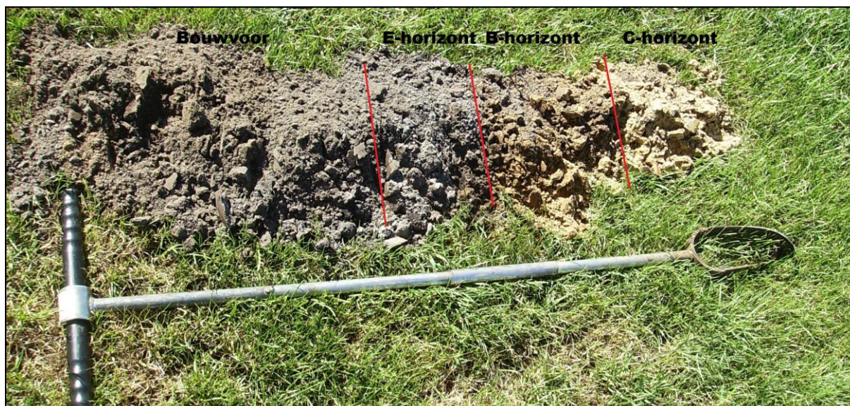
Afbeelding 10. Beeld van boring 4 met hierin de bodemopbouw aangegeven.
