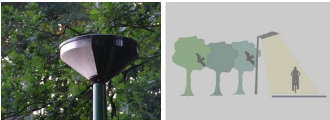
Figuur 5.1: Voorbeeld afschermkap (links) en gerichte verlichting (rechts).
