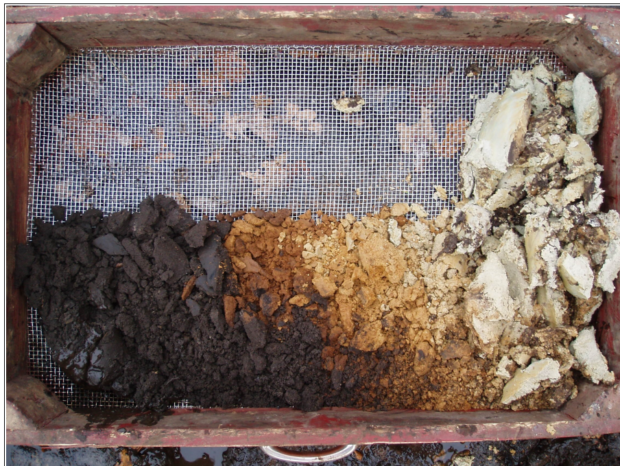
Figuur 7: Drijber, Nijenkamp: het opgeboorde monster van boring 1 in een zeef. Links de donkerbruine bouwvoor en rechts het licht gekleurde keileem. Van het tussengelegen zand is het bruine deel het restant (BC-horizont) van de oorspronkelijke podzolibodem.
