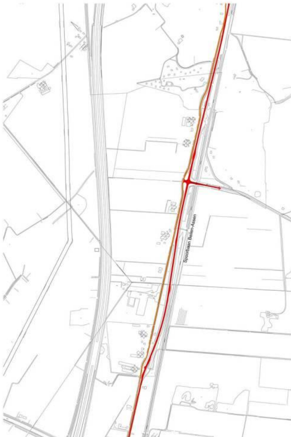
Figuur 5. Situatie tussen Oranjekanaal en Hooghalen van de Asserweg/Beilerweg, parallelweg en provinciale weg naast elkaar met brede tussenberm
