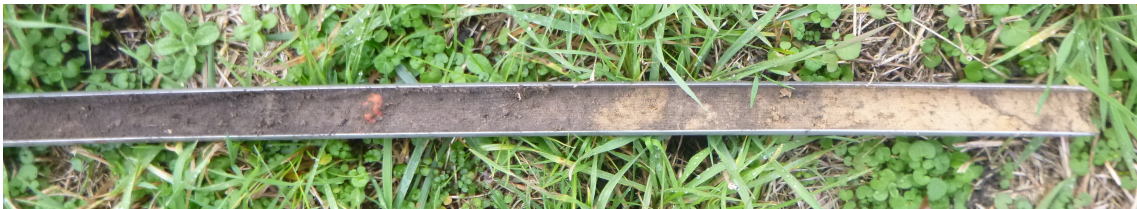
Figuur 7: Westerbork, An de Boerbrink: Foto van boring 4 met links de rommelige humusrijke toplaag met puindeeltjes op de vergraven C-horizont (rechts).
