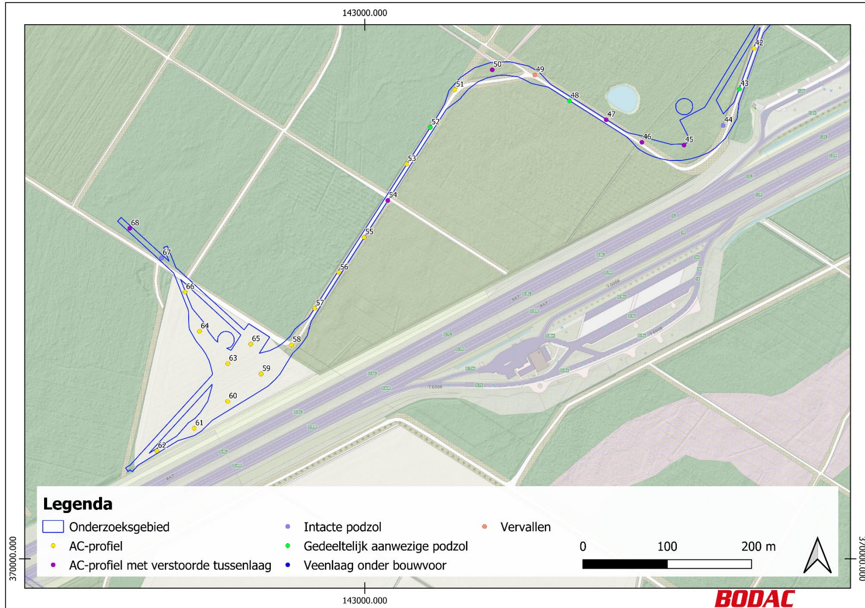
Figuur 8. De verschillende soorten boorprofielen die aangetroffen zijn in de boringen (zuid).
