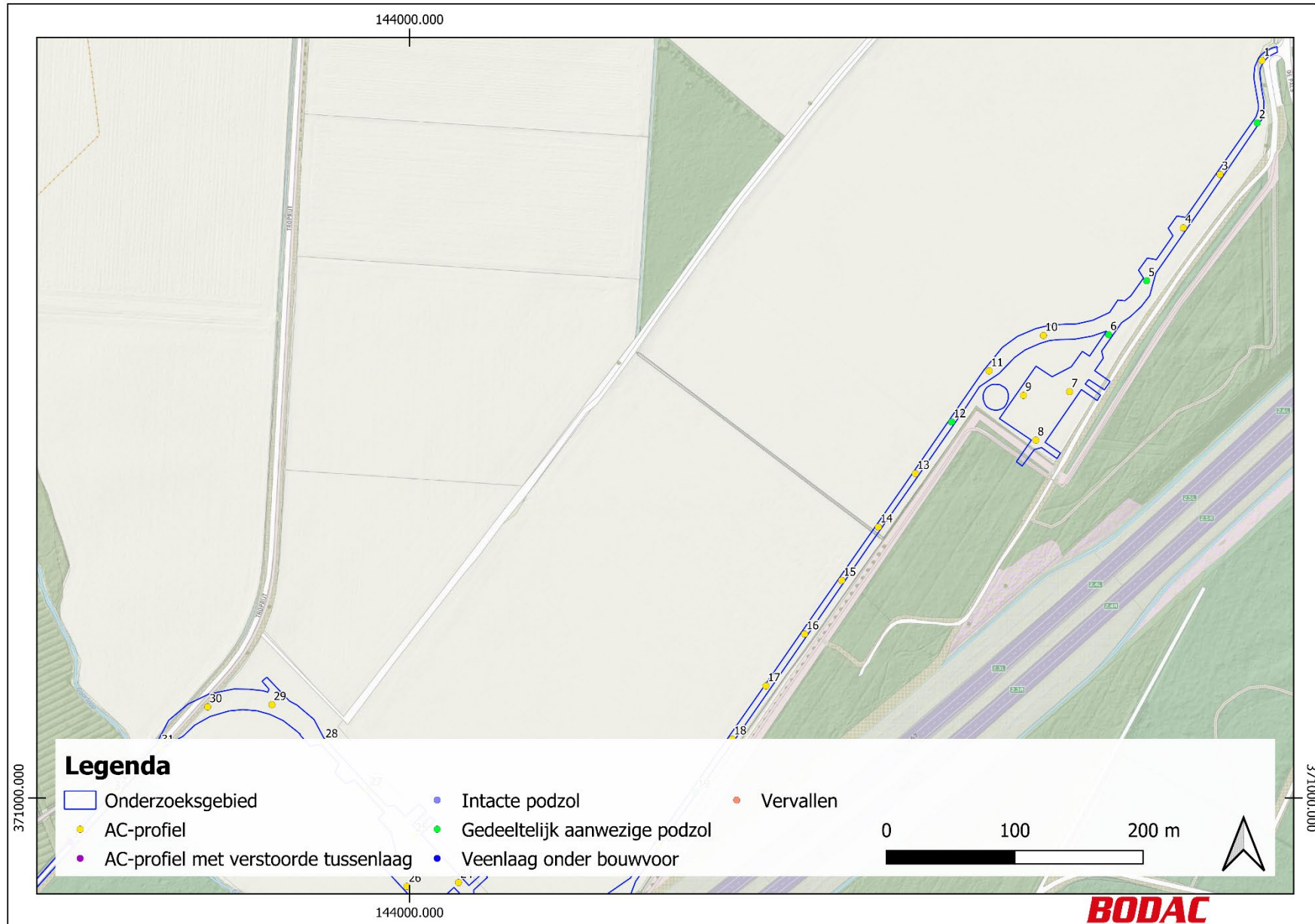
Figuur 6. De verschillende soorten boorprofielen die aangetroffen zijn in de boringen (noord).
