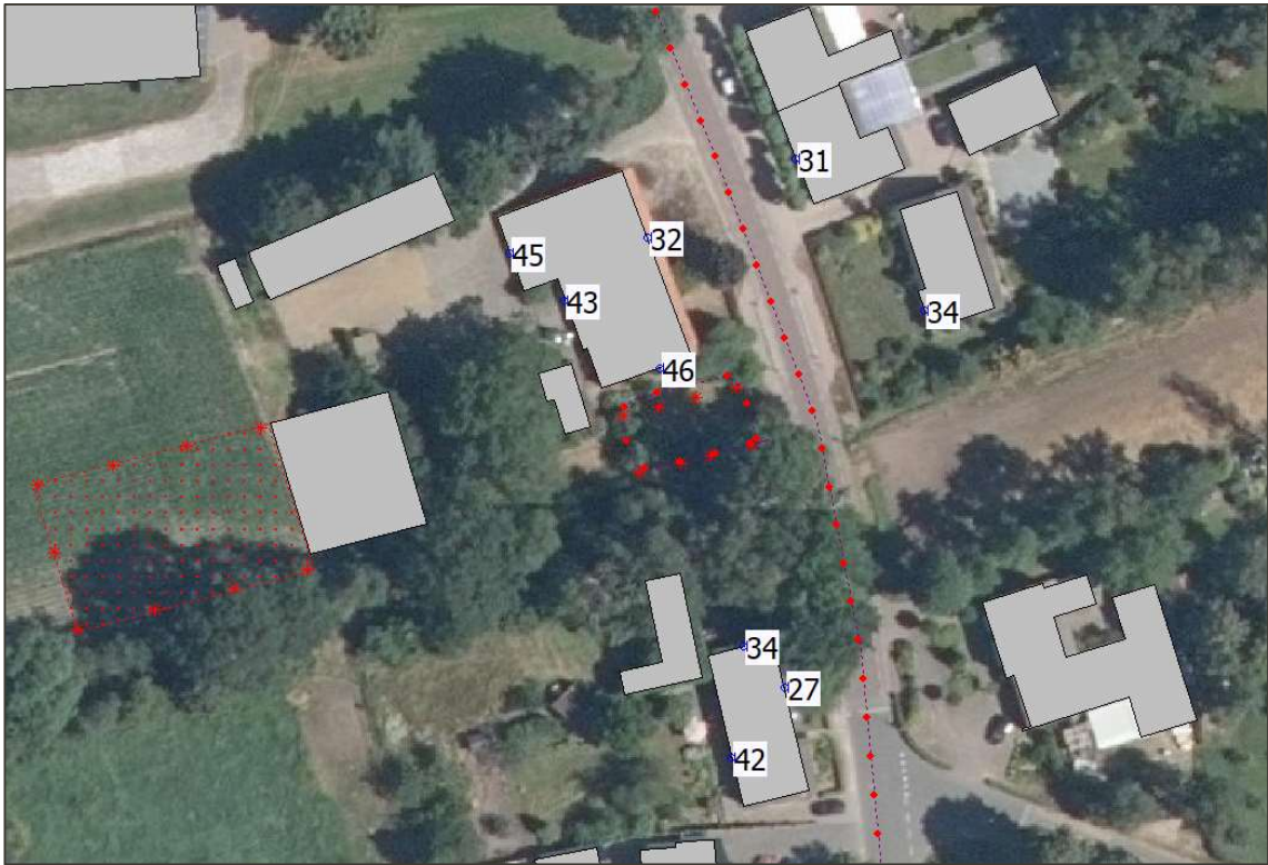
Afbeelding 4 Langtijdgemiddeld beoordelingsniveau ( L_{A,T} ) ter plaatse van de woningen aan de Breestraat (etmaalwaarde in dB(A)) op een hoogte van 1,5 meter boven plaatselijk maaiveld
