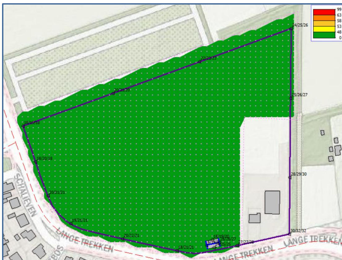
Afbeelding 7. Geluidbelastingen L_{den} (incl. aftrek art. 110g Wgh) Beverdijcken Berekende geluidbelastingen op een hoogte van 4,5 meter (contour) of 1,5 / 4,5 / 7,5 meter (losse rekenpunten)
