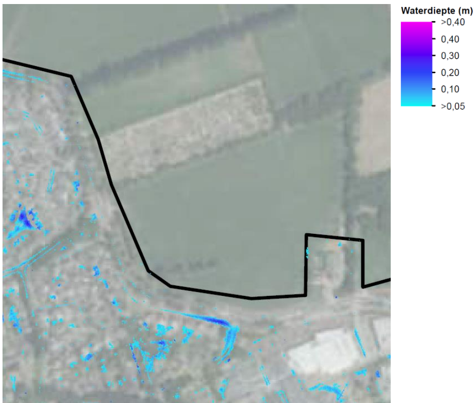
Figuur 8: Water op straat [m] bij Bui 9 (Kennisbank Stedelijk Water). Bui 9 heeft een herhalingsstijd van eens per 5 jaar. De zwarte lijn geeft de grens weer waarvoor de berekeningen zijn uitgevoerd.
