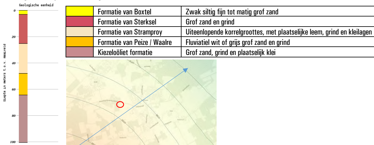
Figuur A: opbouw ondergrond.
