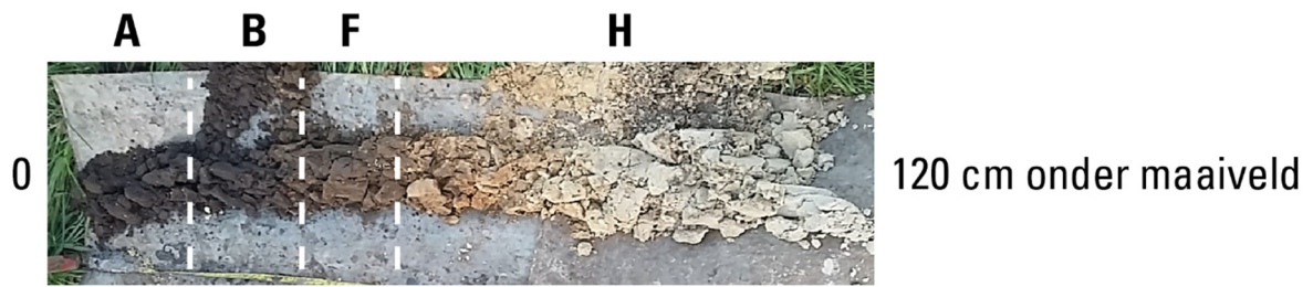
Fig. 3.2. Foto en interpretatie van het opgeboorde materiaal van boring 1. Voor legenda zie figuur 3.1.
