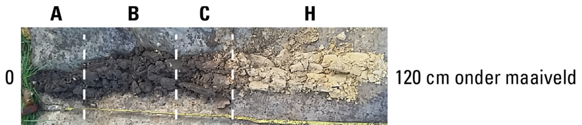
Fig. 3.4. Foto en interpretatie van het opgeboorde materiaal van boring 4. Voor legenda zie figuur 3.1.
