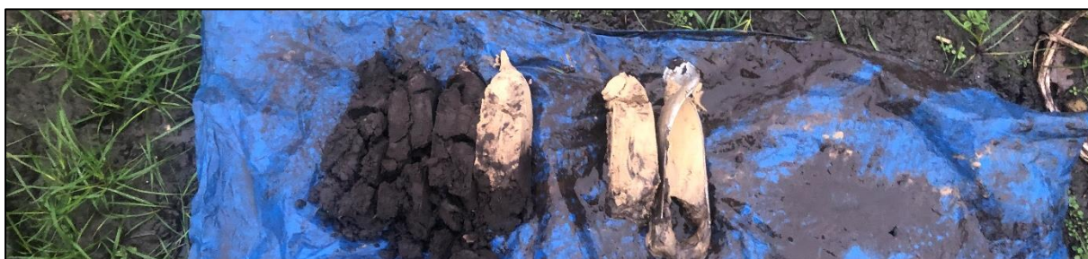
Boring 3: 0-70 cm -Mv. Dieper gelegen zand loopt uit de boor onder invloed van grondwater.
