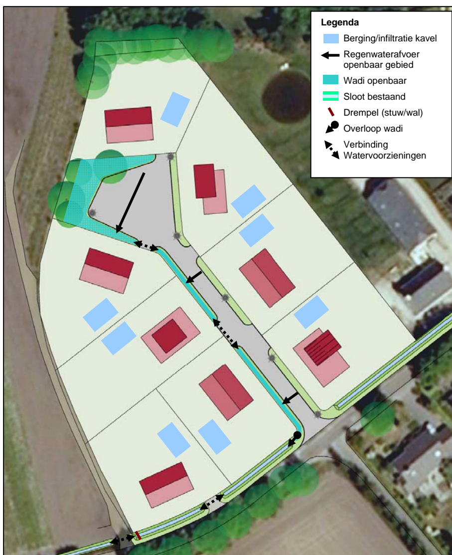
Figuur 4.1: principe watersysteem (ondergrond = stedenbouwkundig plan 15 april 2011)
