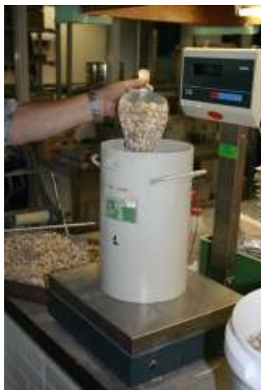
figuur 3 Bepaling stordichtheid grind
