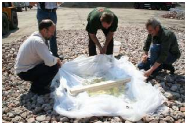
figuur 7 Komvormig gat afgedekt met folie, gevuld met water
