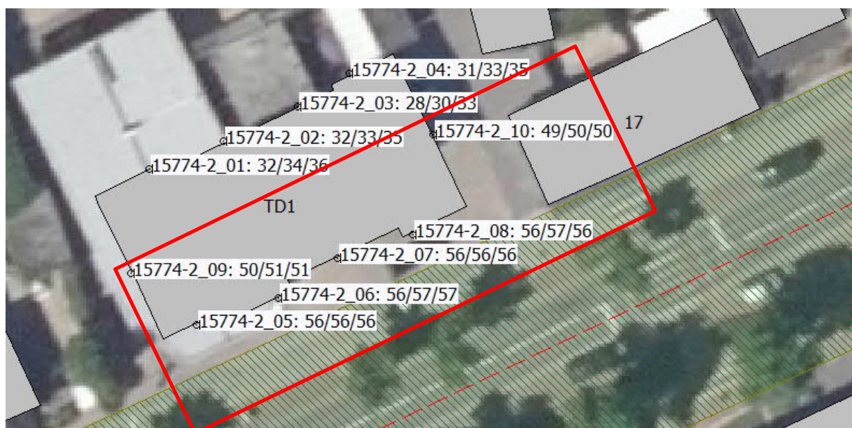
Figuur 5: Belasting gevel overschrijding voorkeursgrenswaarde
