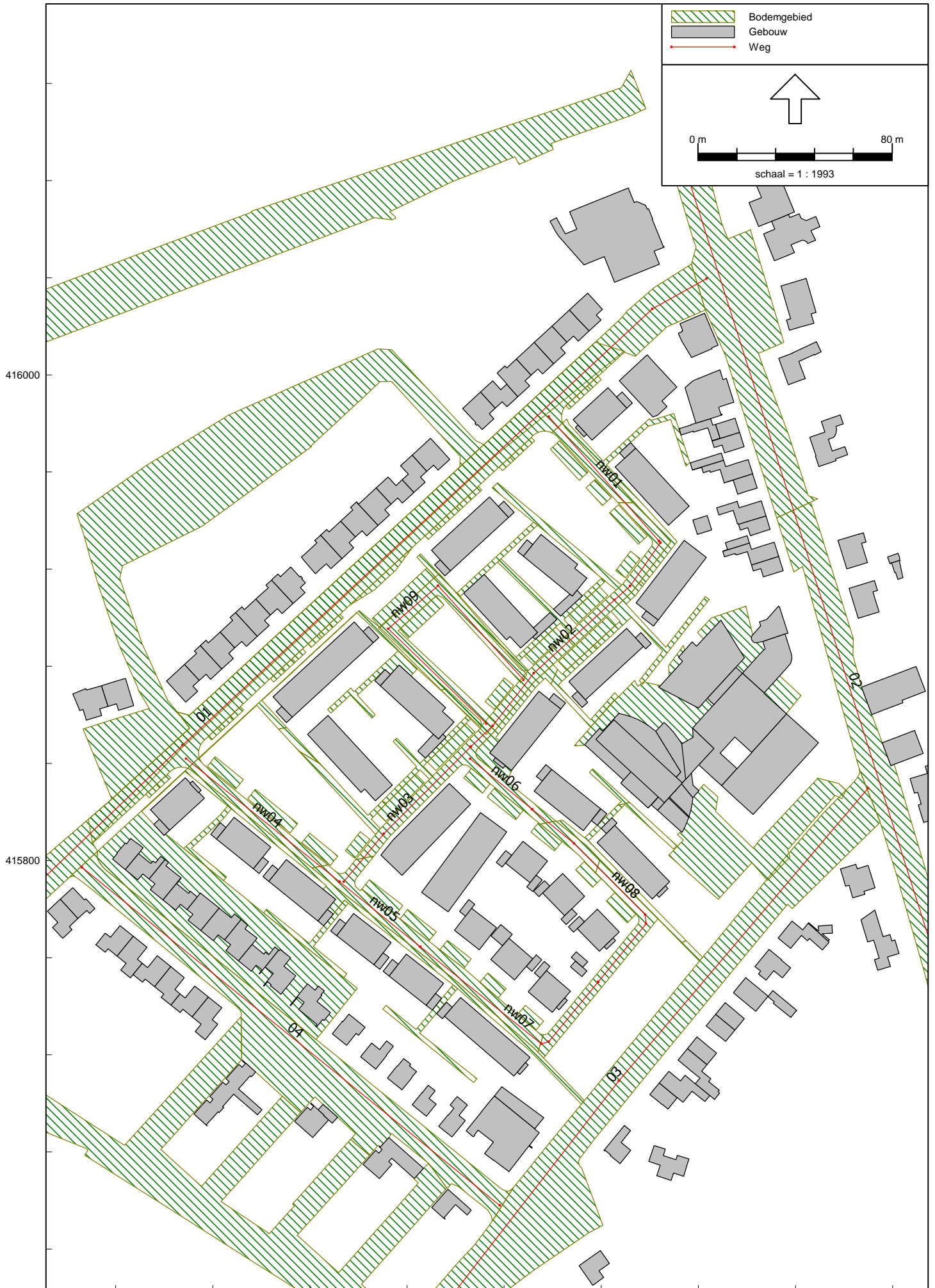
Figuur 2f: Overzicht rekenmodel - geluidbronnen wegverkeerslawaai
