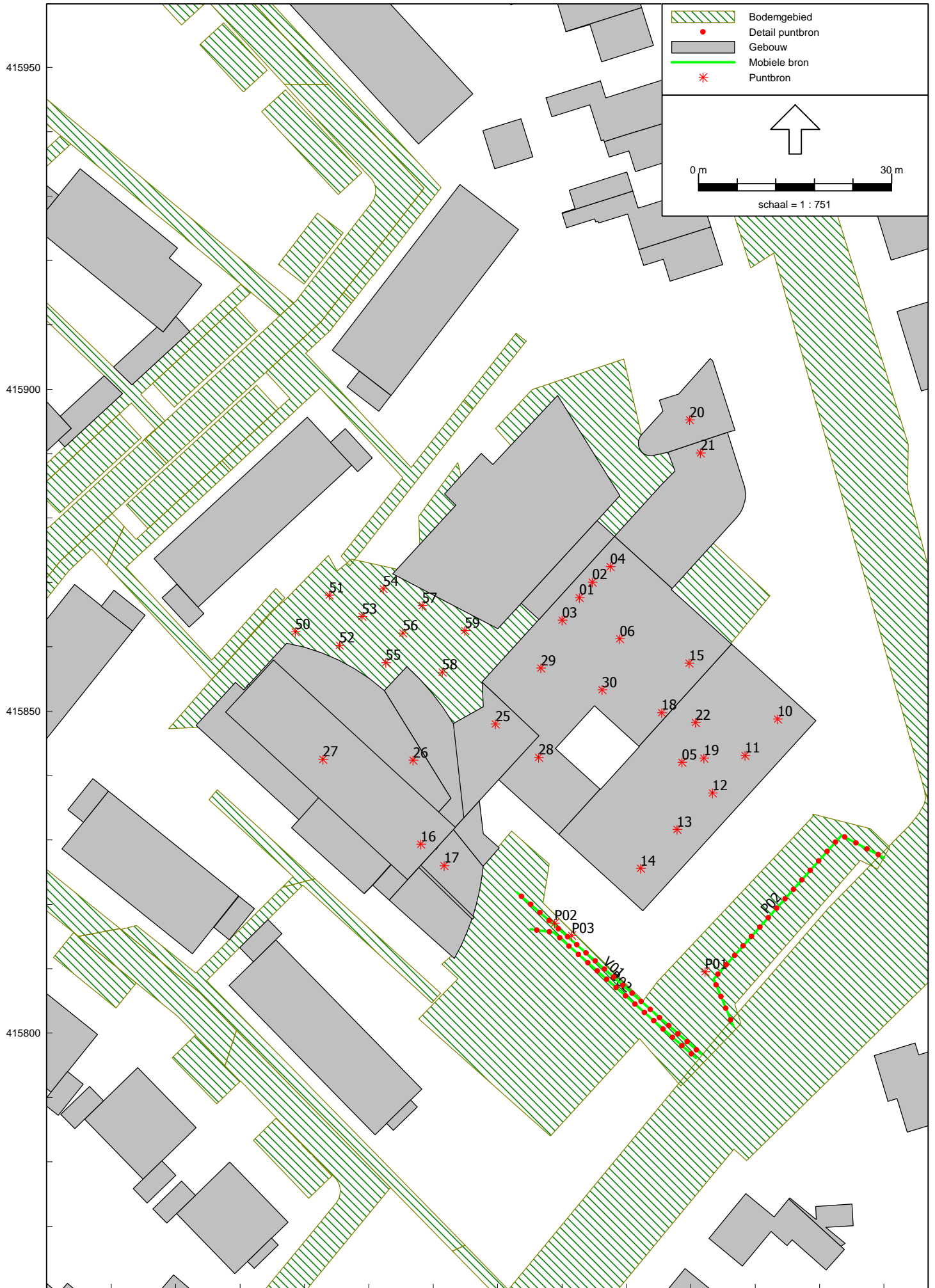
Figuur 2d: Overzicht rekenmodel - geluidbronnen LAm ax
