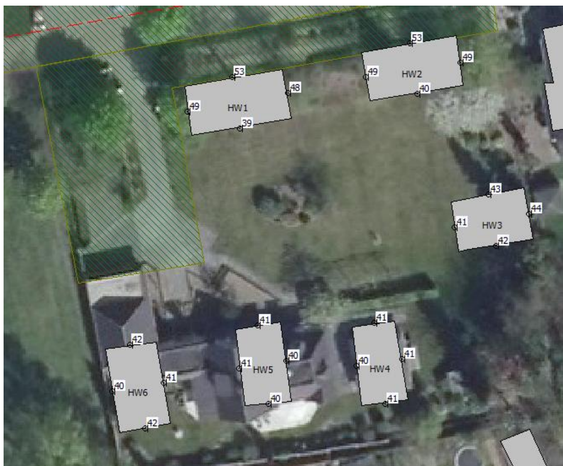
Figuur 4: Geluidbelasting ten gevolge van wegverkeerslawaai op de omliggende wegen excl. aftrek volgens art. 110g Wgh
