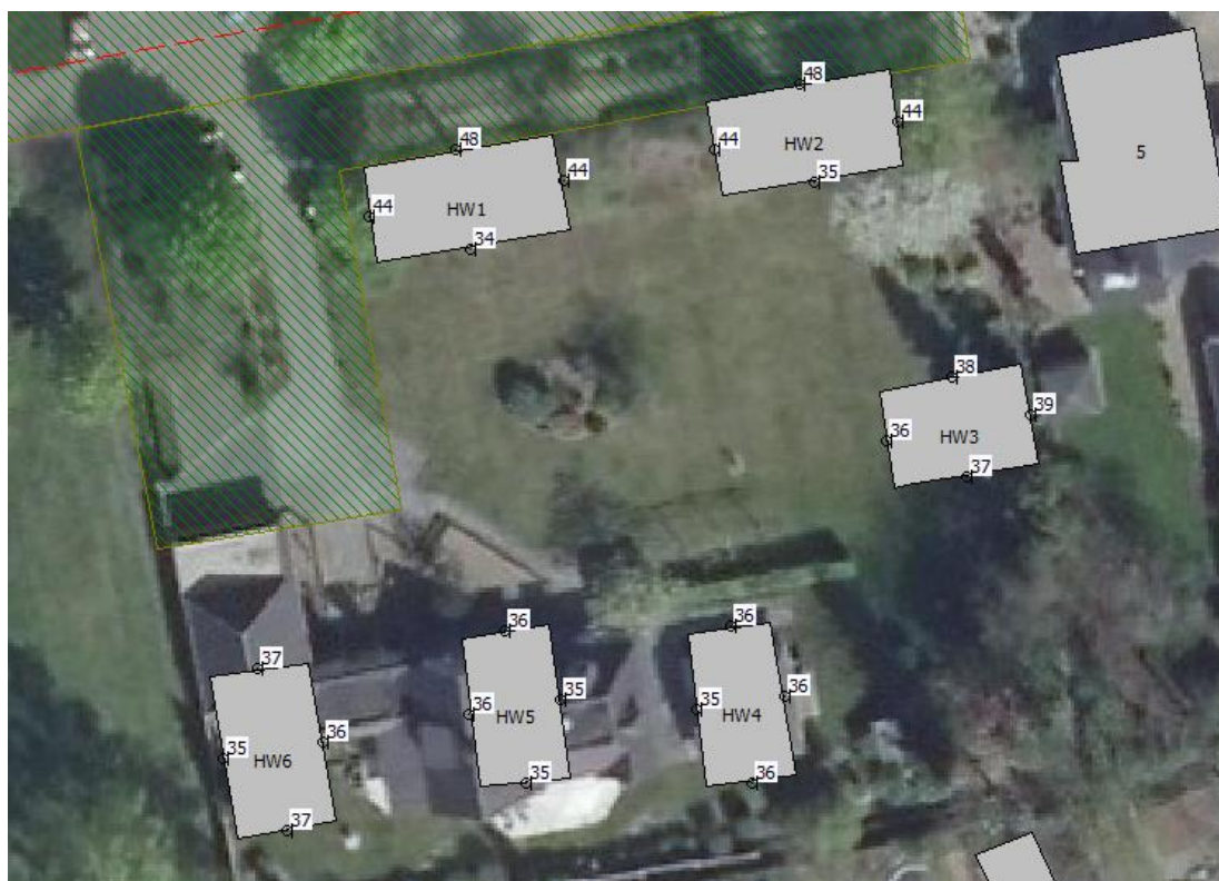
Figuur 3: Geluidbelasting ten gevolge van wegverkeerslawaai op de omliggende wegen incl. aftrek volgens art. 110g Wgh
